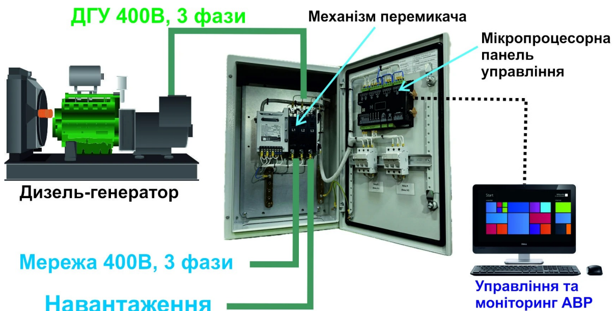
Рисунок 1. АВР між мережею, дизель-генератором і навантаженням; механізм перемикача та панель керування.
